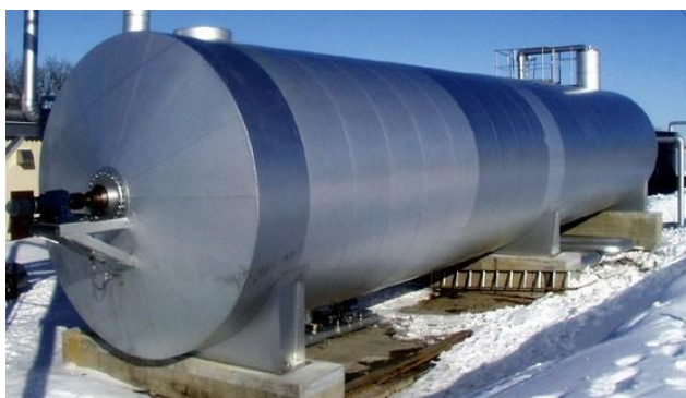
Figura 14.5. Digester orizontal, construit în Danemarca (Nordisk Folkecenter, 2001)
